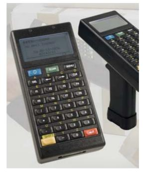
wendungen, die einen zeitnahen Datenaustausch zwischen Terminal und zentralem Computer erfordern, ist das HTE-200 ebenfalls mit DECT-Funk erhältlich.
