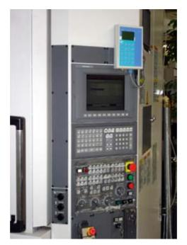
von NC-Daten im Dummy-Verfahren. Des Weiteren dient der GNT.NET Standardterminal zur Erfassung und Rückmeldung von MDE-Signalen.
